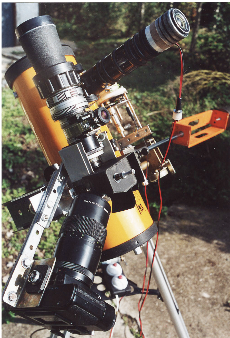
Саморъчно конструиран от автора призмов спектрограф, монтиран до телескоп „Konuspace-500“, 1999 г. Спектрографът има собствен обектив, а телескопът до него служи само за гидиране (проследяване на обекта по време на дългите експозиции, чрез бавно движение на телескопа синхронно с видимото въртене на небесната сфера)
