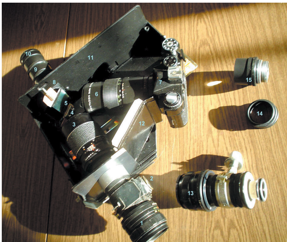
Спектрограф с отразяваща дифракционна решетка, конструиран от автора през 1996 г.
